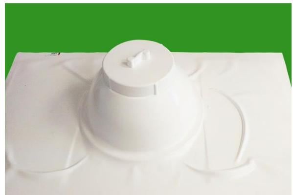
Excellent traitement mécanique des plaques ECO-GEHR PLA-HI<sup>®</sup>, par exemple le poinçonnage (à gauche), l'emboutissage (à droite)
